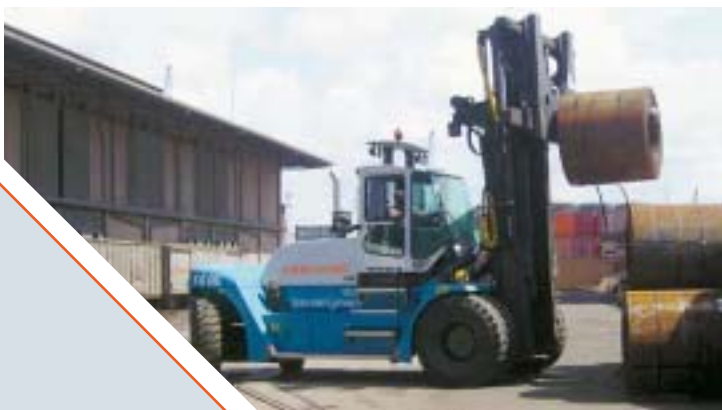
La elevación de bobinas y chapas gruesas de acero requiere carretillas grandes (10-60 toneladas).
