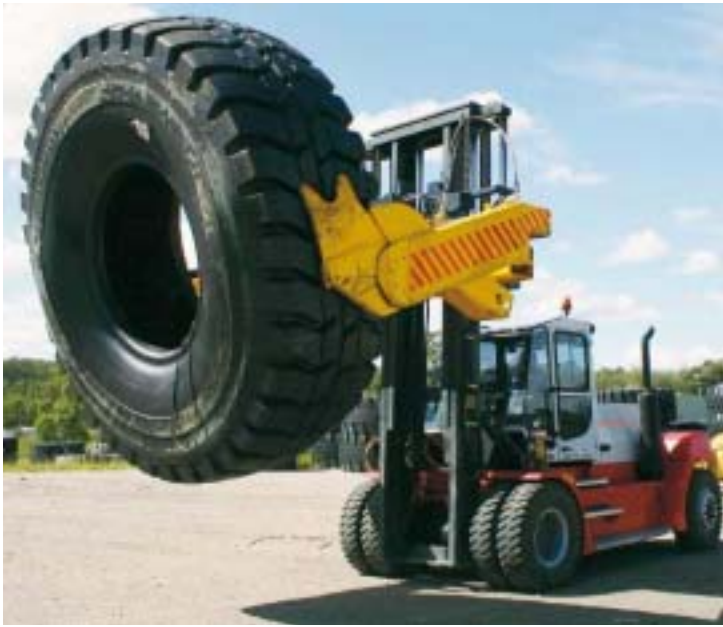
El cambio de ruedas en carretillas gigantes para minería requiere precisión (15-25 toneladas).
