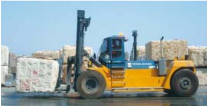
El peso de la piedra. Los bloques de piedra de gran tamaño generan un peso dinámico alto que con frecuencia requiere carretillas potentes (25-45 toneladas).
