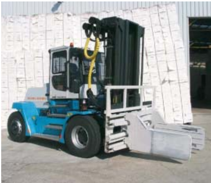
Manipulación de balas de papel con unidad sujetadora integrada (10-13,6 toneladas).
