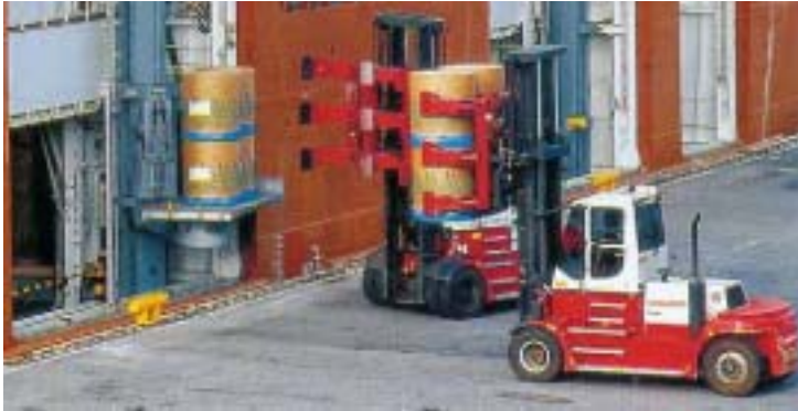
Agarre seguro de bobinas de papel. Manipulación de 2, 4 ó 6 bobinas en el implemento (12-16 toneladas).
